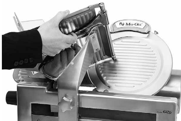
Rys. 6. Korzystanie z dociskacza żywności
